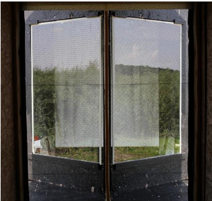
Abbildung 1: Prüfscheibe mit feinem Punktraster (links) und unmarkierte Referenzscheibe (rechts) im WIN-Test. Prüfmarkierung: Punktraster mit 3mm Punktdurchmesser, Deckungsgrad 3,6 %, RAL 7016 (anthrazit), auf Position #1 einer monolithischen 4 mm Floatglasscheibe. Auf dem Foto ist vor der rechten Scheibe das Auffangnetz zu erkennen, für Vögel ist es aufgrund seiner Feinheit von 0,1 mm Fadendurchmesser nicht erkennbar.
