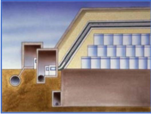
Abbildung 9: Schnitt durch das versiegelte Lager (IAEA 2005)
