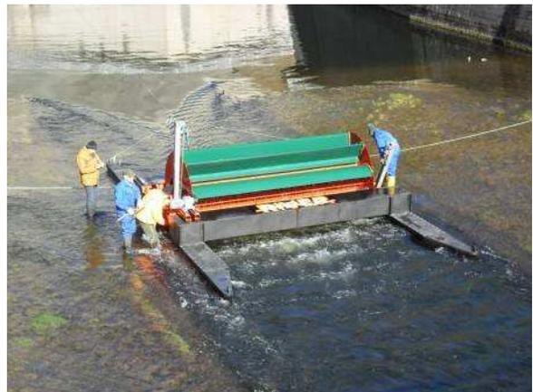
Abbildung 4 Strömungskraftwerk "Energy Floater"
