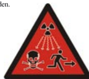
Zusätzliches Warnsymbol für ionisierende Strahlung für Quellen der Klasse 1-3 (ISO 21482)
